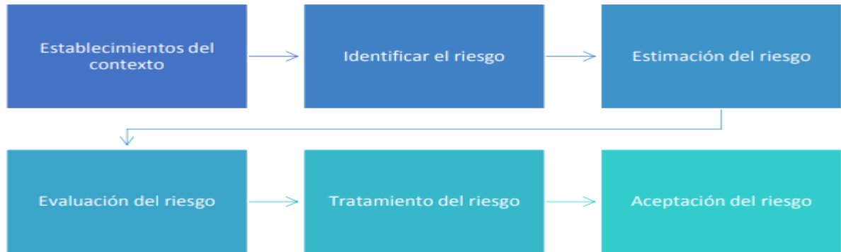
Ilustración 1. Estructura general de la metodología de riesgos
